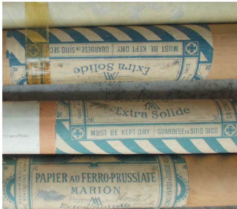
Rotoli di “Carta al ferro Prussiato” che fan parte del lascito Manini.
